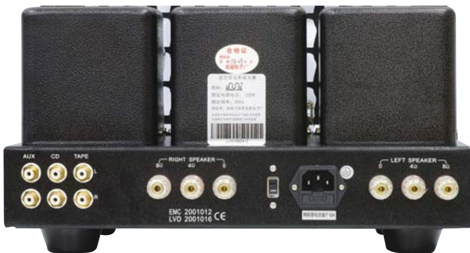
I morsetti di uscita sono simil-WBT e sdoppiati per carichi nominali di 8 e 4 ohm. Dai test di carico limite emerge che in pratica quello più consigliabile, a meno di altoparlanti dall'impedenza abnormalmente elevata, è quello da 4 ohm.
