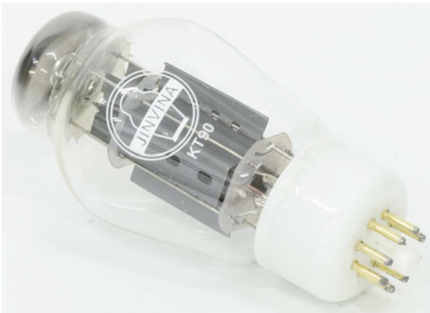
Una singola KT90 per canale polarizzata in classe A permetteva al modello MC368-B902 di erogare una quindicina di watt. Qui la stessa valvola è usata in push-pull, ed in configurazione ultralineare, per ottenere 70 watt nominali, valore peraltro ben conservativo dato che una coppia di questi tubi permetterebbe di superare i 150 watt efficaci (accettando naturalmente una minore linearità ed una più breve vita operativa).
