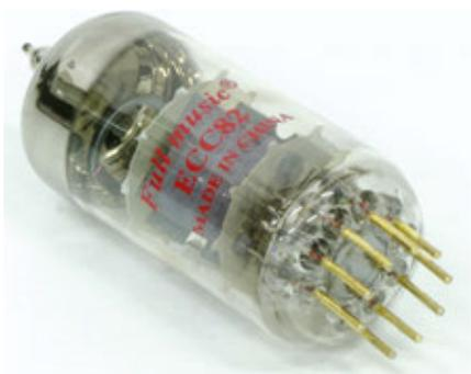
La ECC82 è qui usata come driver ed invertitore di fase per il pilotaggio push-pull delle finali, con le quali è accoppiata in AC.
